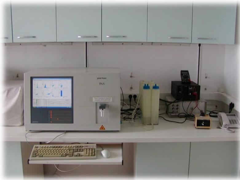
*Slika 5.* Partec PAS protočni citofluorimetar
