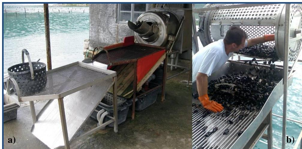
**Slika 5.** Strojevi za čišćenje i sortiranje dagnji; **a)** na kopnu; **b)** na plovilu (foto: Anika Marinović).
