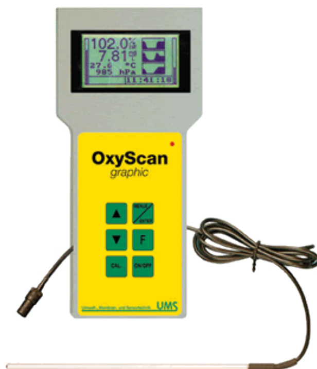
Slika 17. Polarografska sonda za mjerenje količine kisika otopljenog u vodi marke UMS, tip Oxyscan graphic (UMS Gmbh, Njemačka). Izvor: http://www.ums-gmbh.de/Produkte/ .
