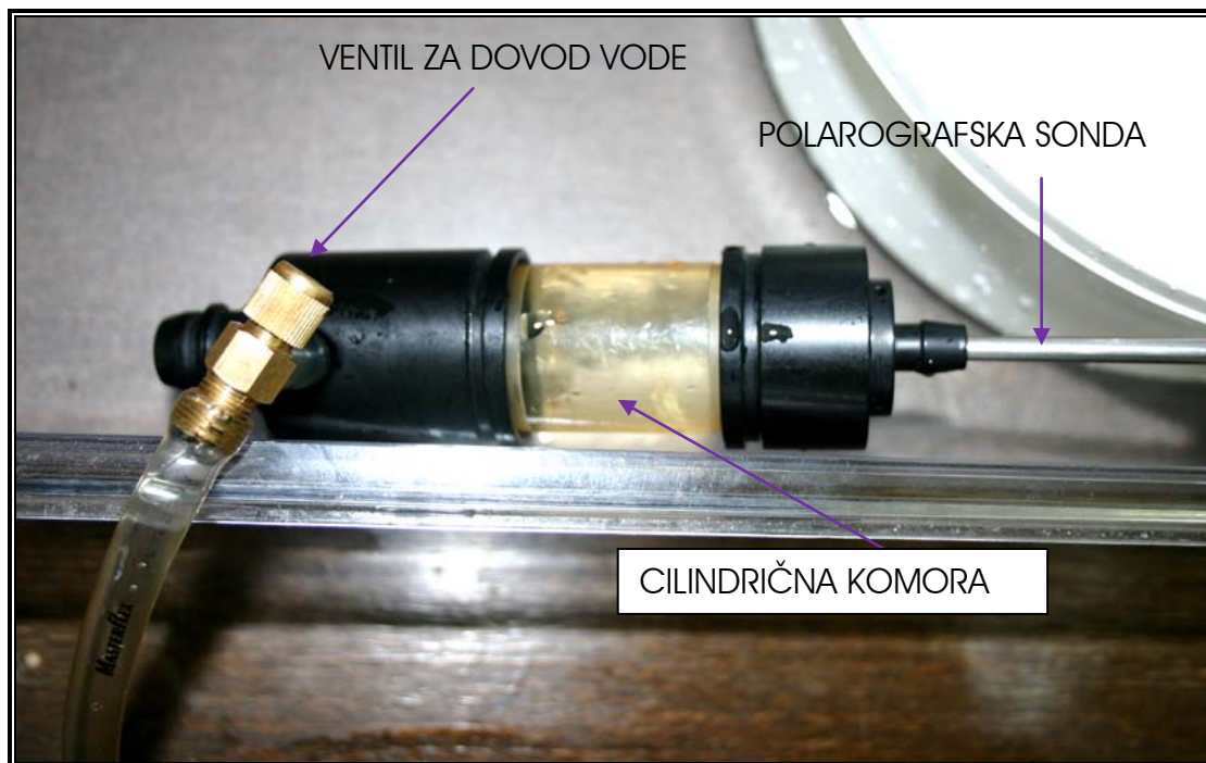
Slika 16: Mjerna komora cilindričnog oblika korištena za mjerenje potrošnje kisika u zatvorenom sustavu.
