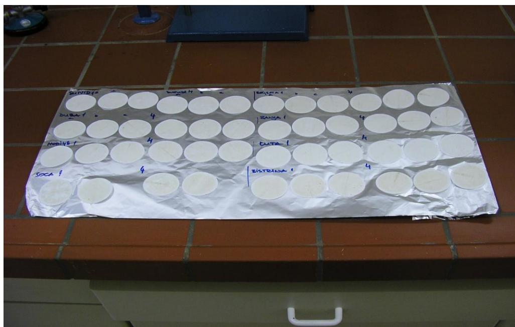
Slika 16. Whatman GF/C filteri u triplikatu priprema za sušenje – određivanje ukupne partikularne tvari (foto MARIBIC)
