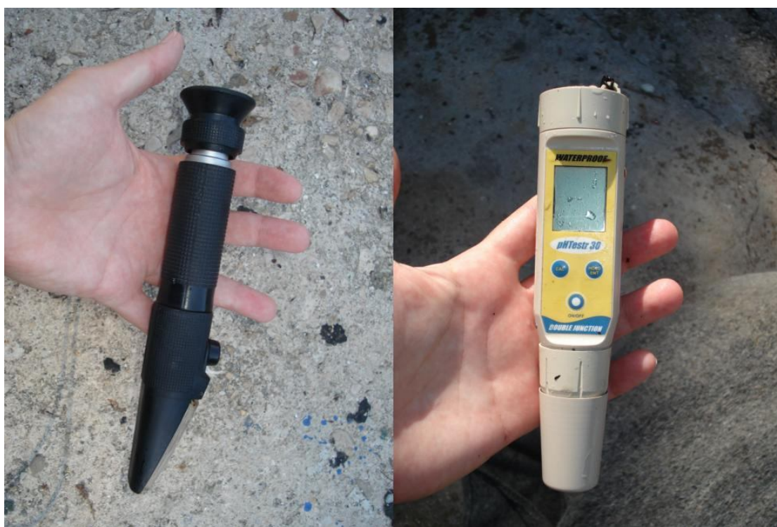
Slika 3. Refraktometar za mjerenje slanosti i sonda za mjerenje temperature
