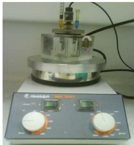
Slika 8. Mjerenje vrijednosti  $pO_2$  zatvorene komorice
