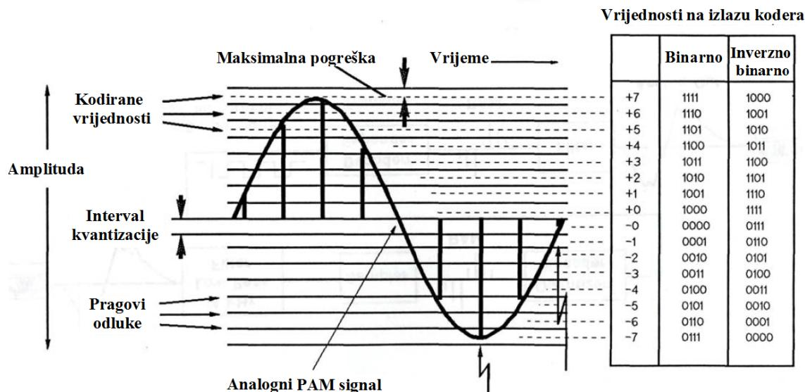
Slika 5.4. Amplitudska diskretizacija i kodiranje vremenski diskretiziranoga signala
