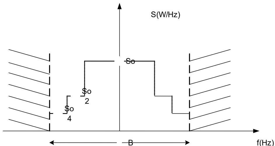
Slika 4.11. Razdioba spektralne gustoće snage signala
