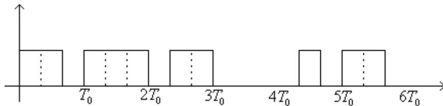
Slika 5.9. Vremenski oblik signala na izlazu iz bloka za kodiranje
