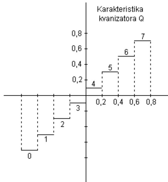
Slika 5.7. Karakteristika kvantizatora
