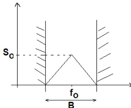
Slika 4.10. Razdioba spektralne gustoće snage signala
