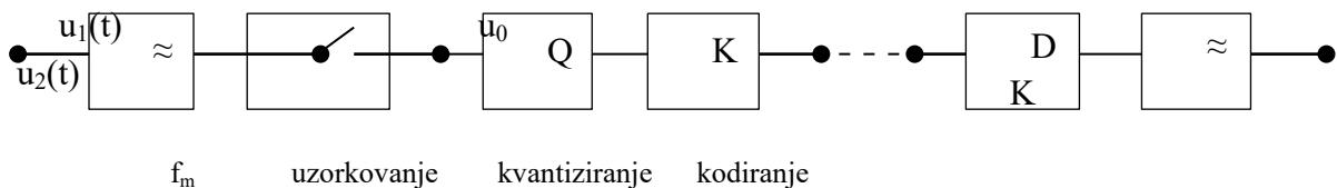
Slika 5.5. Blok-shema PCM sustava
