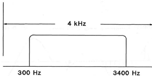
Slika 5.2. Ograničavanje frekvencijskog pojasa signala
