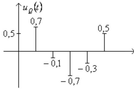
Slika 5.8. Vremenski oblik signala na izlazu iz bloka za kvantiziranje
