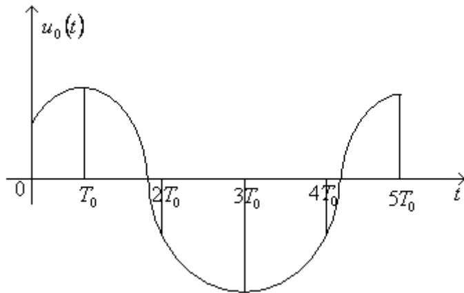
Slika 5.6. Vremenski oblik signala na izlazu iz bloka za uzorkovanje
